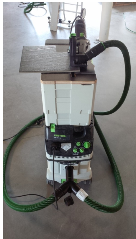
Festool stofzuiger CLEANTEC CTM 36 AC-HD met SELFCLEAN-filterzak SC FIS-CT 36, aangesloten met 3,5 meter afzuigslang Ø36 mm naar haakse slijper en 3,5 meter afzuigslang Ø27 mm naar stofbox (of gelijkwaardig)
