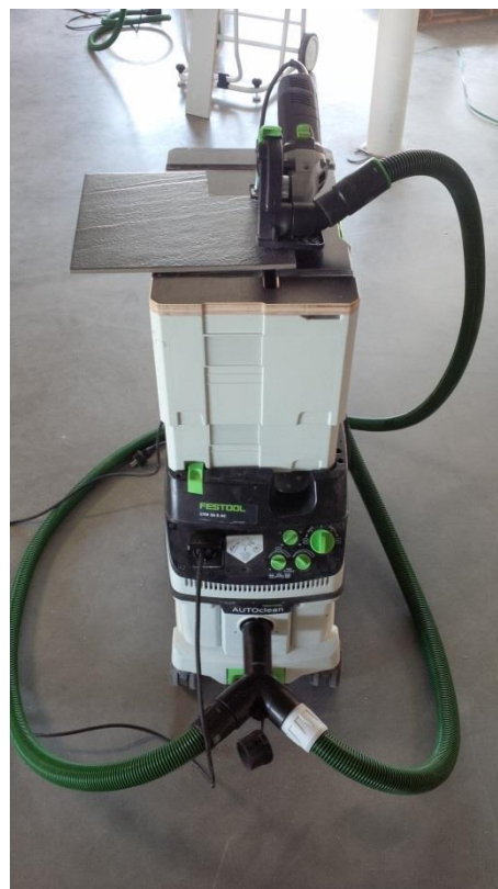
Festool stofzuiger CLEANTEC CTM 36 AC-HD met SELFCLEAN-filterzak SC FIS-CT 36, aangesloten met 3,5 meter afzuigslang Ø36 mm naar haakse slijper en 3,5 meter afzuigslang Ø27 mm naar stofbox (of gelijkwaardig)
