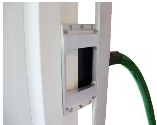
HMB basismal incl. afzuigadapter t.b.v. scharnieren, sluitplaten, invisibles en sluitkommen met industriële stofzuiger
