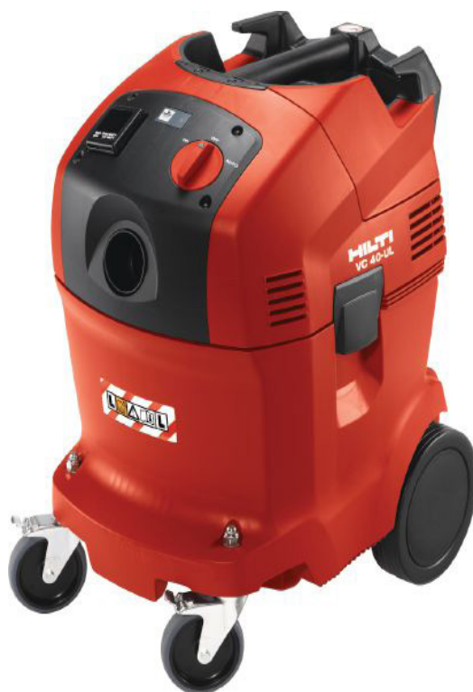
Hilti stofzuiger VC 40-UL met 5 meter afzuigslang Ø 36 mm. Met gebruik stofzak VC 40. Filterreiniging: handmatig (of gelijkwaardig)
