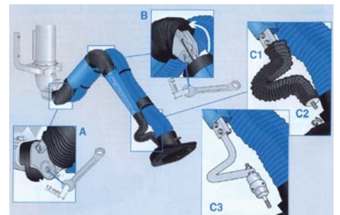
Figuur 1 Dynamisch BeheersSysteem (DBS) met hangbaan, flexibele afzuigkanalen, telescopisch afzuigkanaal en flexibele afzuigarmen verplaatsbaar in x-y-z richting
