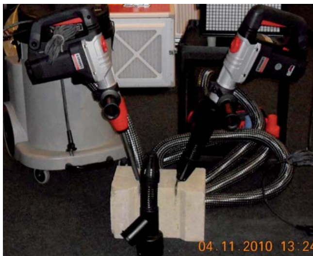
Figuur 1. Dusttool afzuigstelsysteem met Sparky BP 540 ce hakhamer (en Numatic NDD900(A) stofzuiger met aircleaner)
