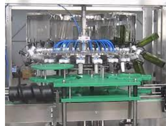
Cleaning/flush en transport systeem voor flessen
