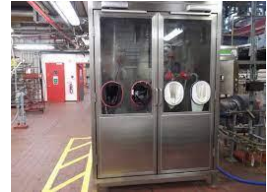
Afvulstelsysteem met glovebox en afzuiging
