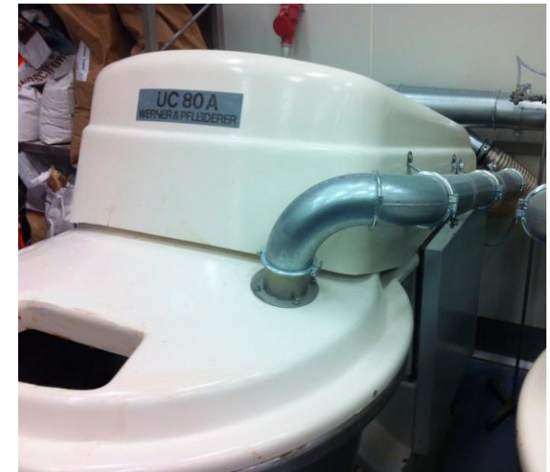
Geïntegreerde afzuiging op een deksel
