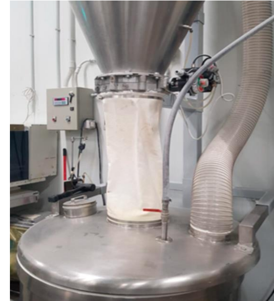
Geautomatiseerde en afsluitbare mengkuip
