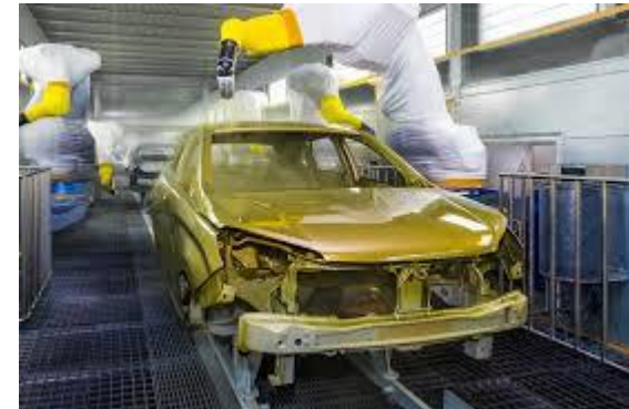
Geautomatiseerd en geventileerde verfspuit systeem
